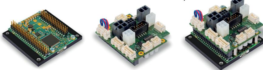
EPOS4 est une commande de positionnement modulaire et digitale. Elle est adaptée aux mo-
