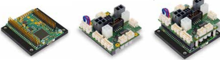
EPOS4 是一款模块化数字式位置控制器。适用于配增量或绝对值编码器的永磁体DC电机和电子换向式无刷EC电机，最大连续功率可达 1050 W。多种操作模式提供了很高的灵活性:控制器适用于各种自动化和机电一体化驱动系统。
